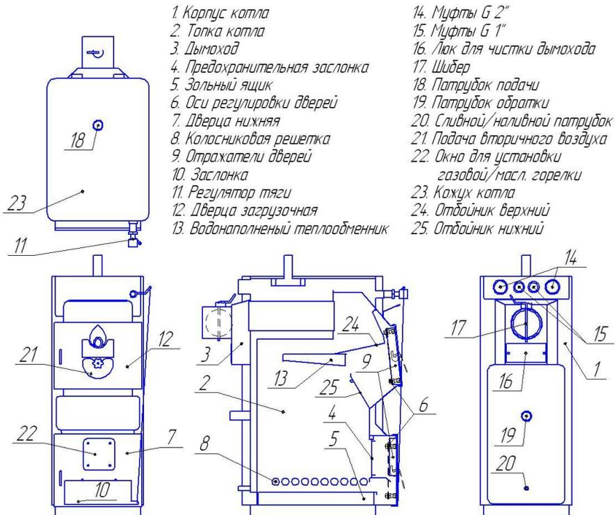
Котел состоит из корпуса 1, топки 2, дымохода 3. В нижней части топки устанавливаются предохранительная заслонка 4 и зольный ящик 5.
