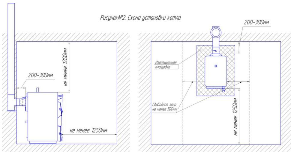
Если котел устанавливается не на фундамент, а на деревянный пол, то для его изоляции требуется выложить площадку толщиной 1/4 кирпича, в стороны от котла на 250 мм. Сверху кирпичную кладку закрыть металлическим листом или стяжкой из марочного цементного раствора.
